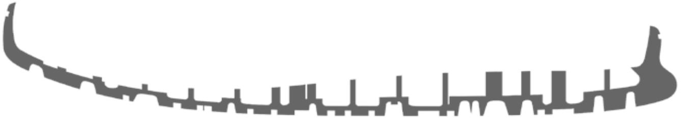
Sohlenquerschnitt | Profiltiefe 4,0 – 3,0 mm | Effektivstärke 1,5 mm
