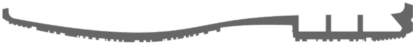
Sohlenquerschnitt | Profiltiefe 2,7 mm | Effektivstärke 4,0 mm
